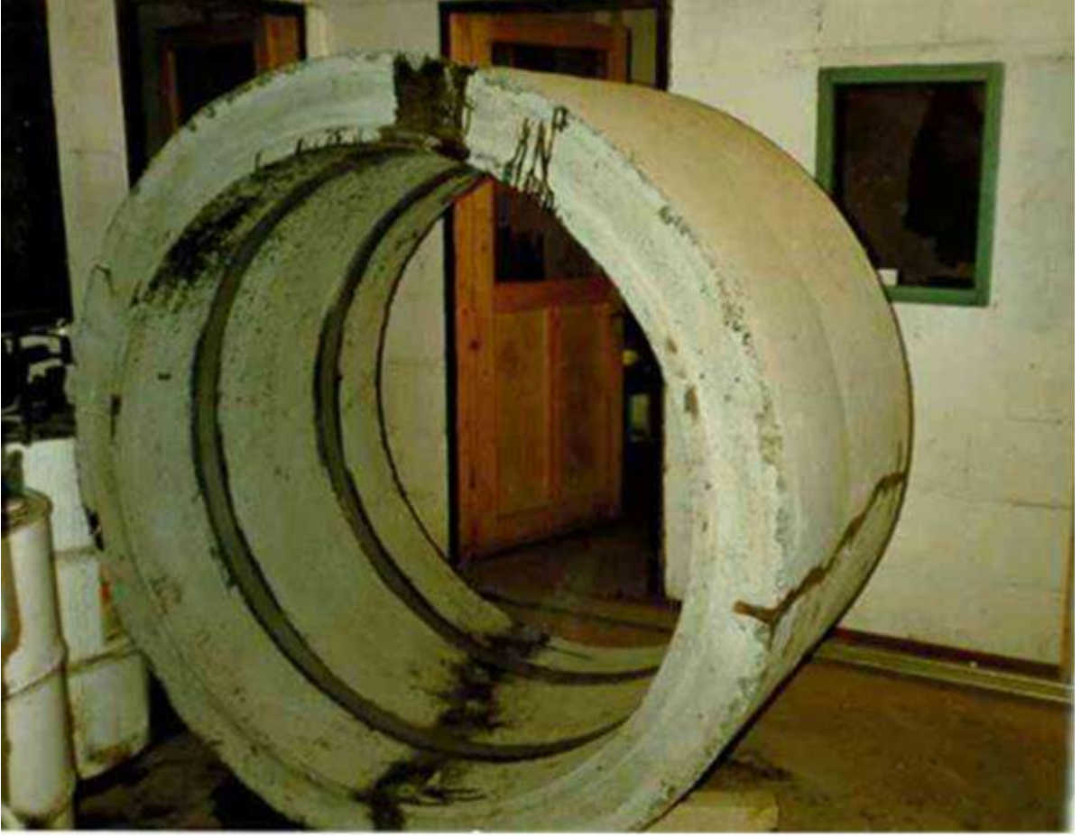
KIRIMI YAPILMIS BORUNUN STATİK TAKVİYE İLE ONARIMI VE GÜÇLENDİRİLMESİ
