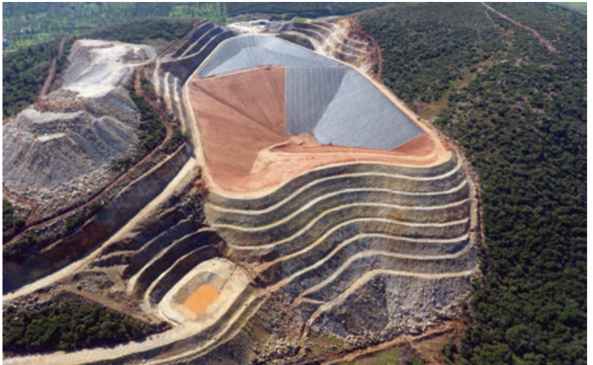
BentoShield ile maden atık sahasında geçirimsizlik tabakası oluşturulmuştur.
